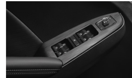
Электростеклоподъемники четырех дверей с автодоводчиком со стороны водителя
